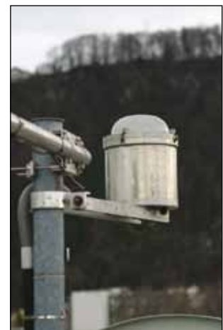
Figur 2. Uppvärmd mätutrustningen med ljusvärde sensorer placerad på en container. Källa: Schäcke
