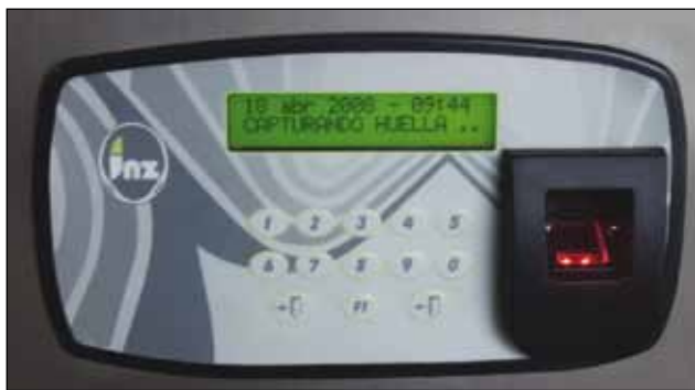
Figur 4. Tack vare gränssnittet för passersystem (fingeravtryck) till KNX system, är ett kundanpassat system och kontroll möjligt.
